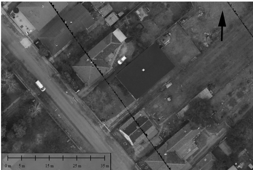
3. ábra Az IS 4 mérőkamerával készített ortofotók a képek találkozásánál. A pontosság a képszéleken is szembeűnő. (Az ortofotók pontossága a talajszinten értelmzett. A járdák a képszélen sem térnek el egymástól 10-20 cm-nél jobban.)
